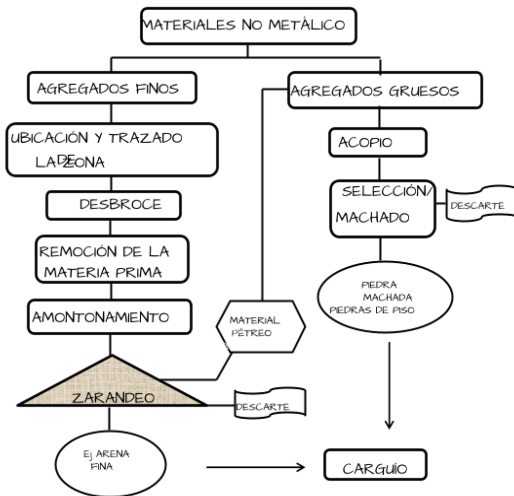
Figura 01:Proceso extractivo de la arena
